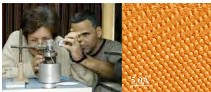
Figura 1: Microscopio de efecto túnel fabricado en el IMRE con la colaboración del Centro de Nanociencias y Nanotecnologías de Ensenada, México. Imagen de resolución atómica de una superficie de grafito tomada con el mismo y ampliamente divulgada en Cuba.
