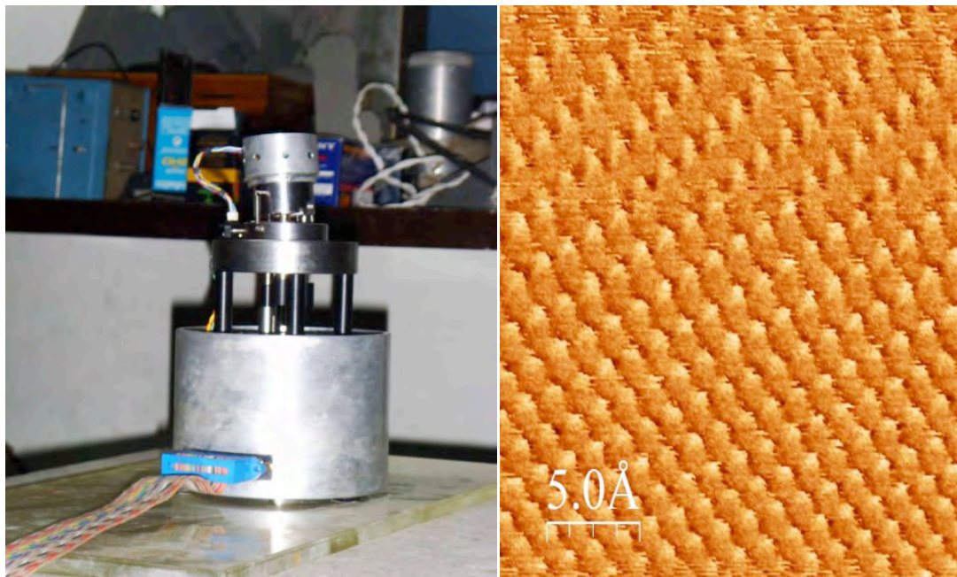
Figura 17: Microscopio de efecto túnel fabricado en el IMRE con la colaboración del Centro de Nanociencias y Nanotecnologías de Ensenada, México. Imagen de una superficie tomada con el mismo.
