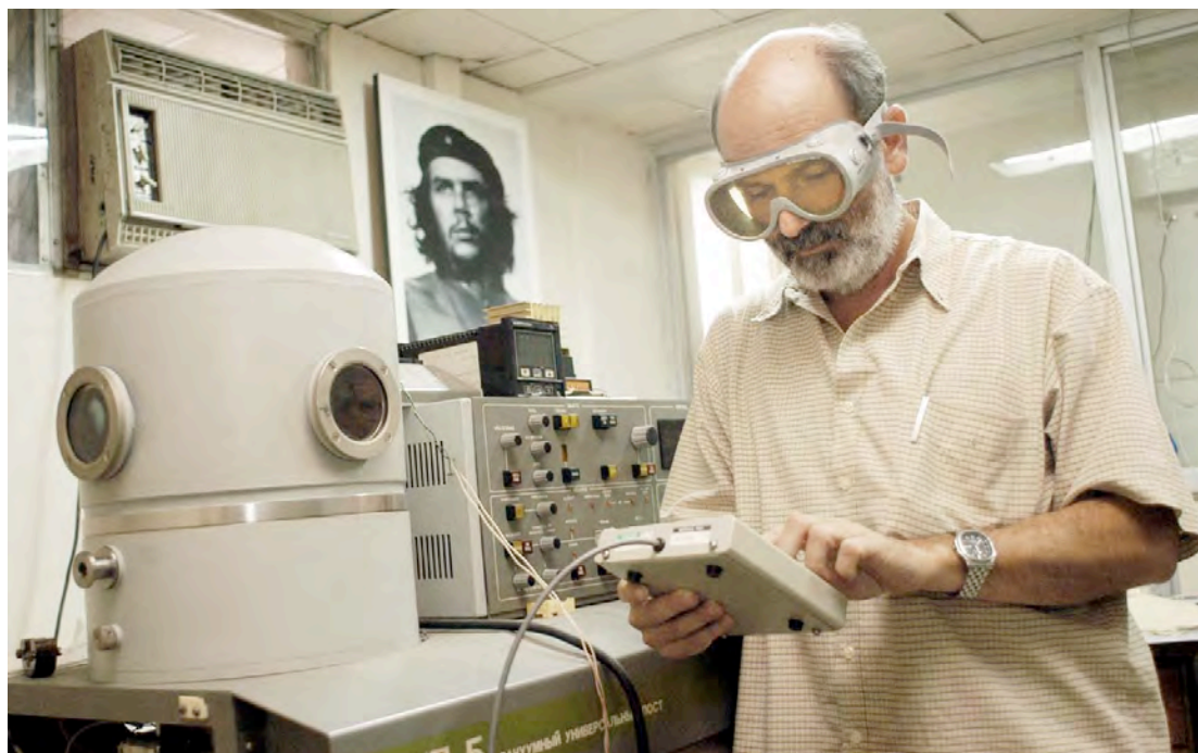
Figura 2: Instalación experimental para la deposición de capas mediante laser pulsado (PLD) en el IMRE. Universidad de La Habana.
